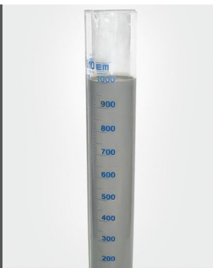
Mesure de l'exsudation de ThermoCem PLUS en ratio eau/mat.solide de 0,8.
