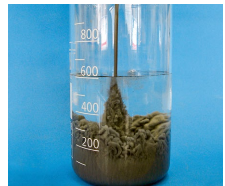
Exemple de coulage par le dessus et de lessivage à travers l'eau = ségrégation.
