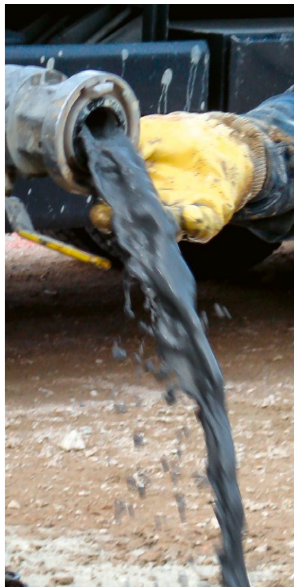
Écoulement transitoire d'un mélange eau/coulis ThermoCem.
