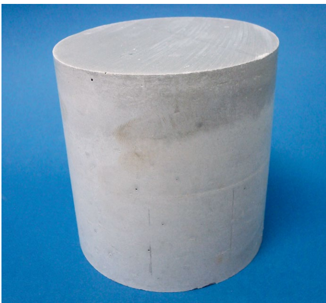
ThermoCem Basic après 10 cycles gel-dégel, bain d'eau permanent.
