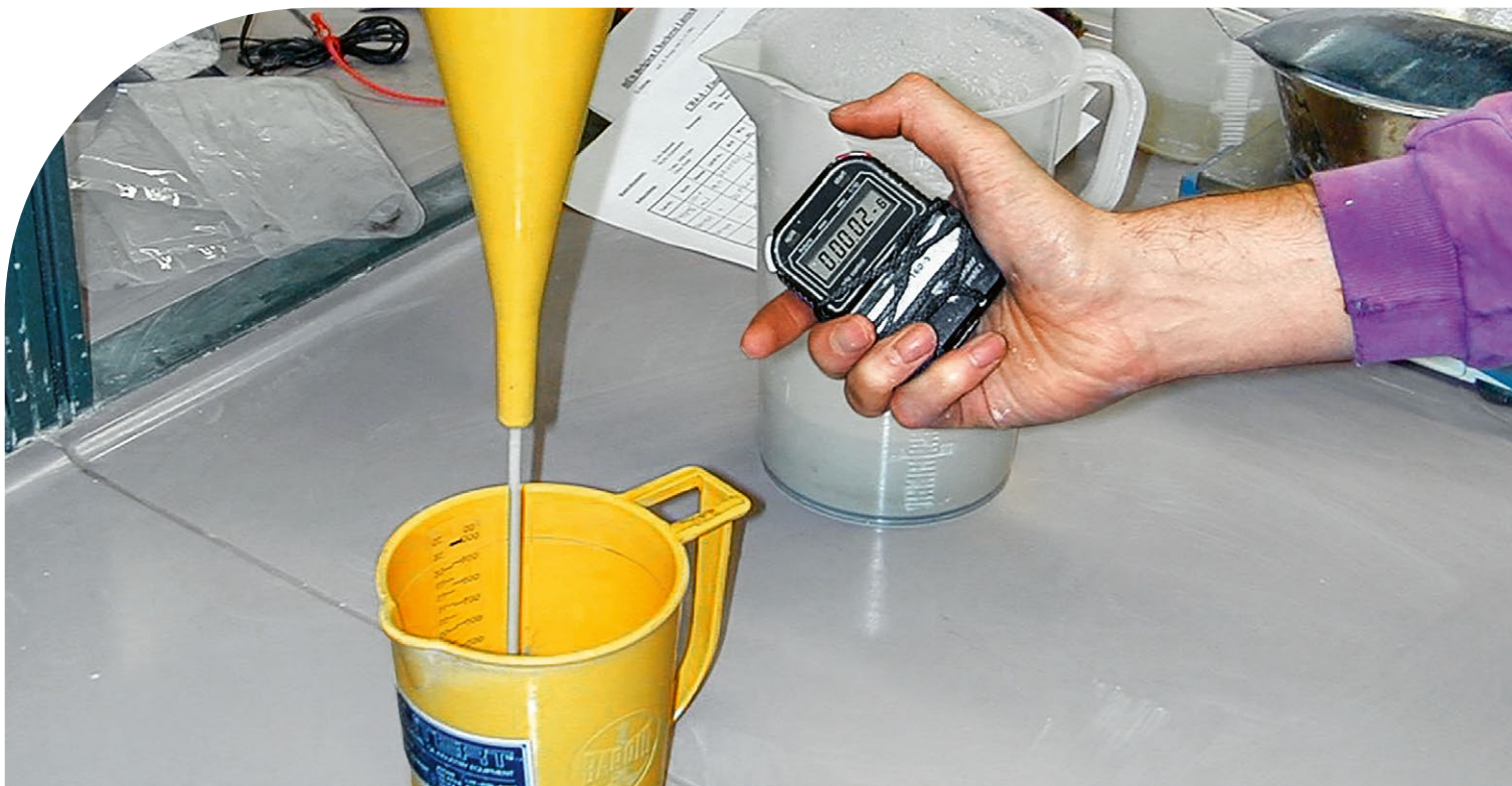
Détermination de la viscosité Marsh après le mélange.
