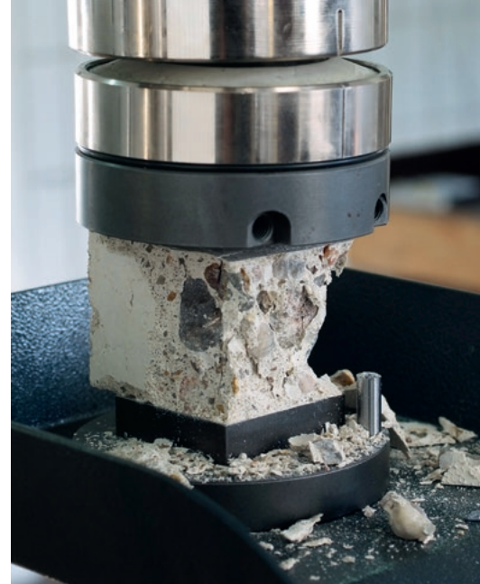
Druckfestigkeitsprüfung bei einer Fließestrichprobe.
