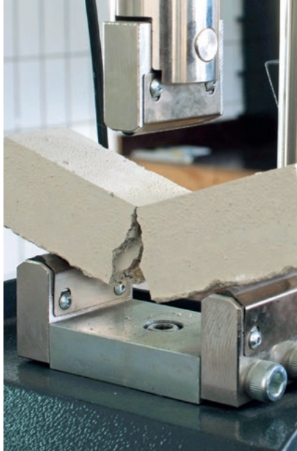
Biegezugfestigkeitsprüfung bei einer Fließestrichprobe.
