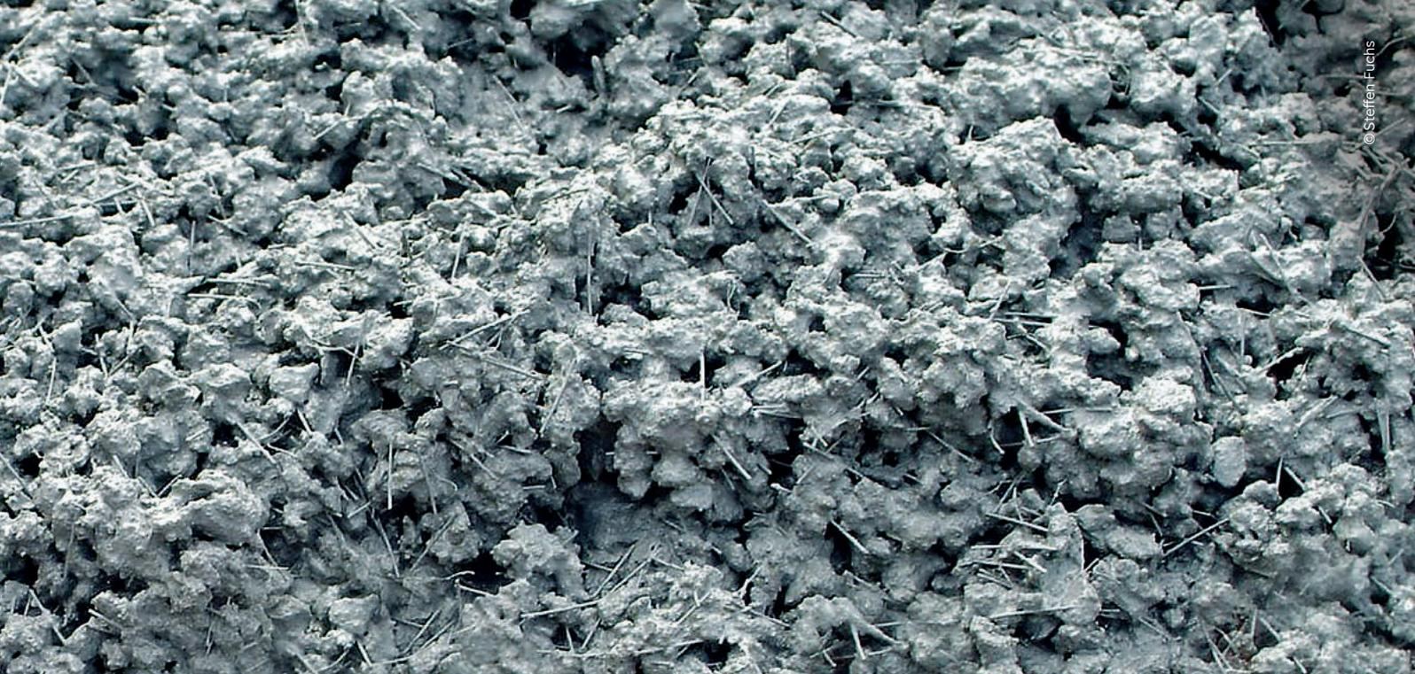
Das Mischungsverhältnis von Beton und Stahlfasern ist für die Eigenschaften des Endproduktes entscheidend. Die Auswahl der Stahlfaser richtet sich nach dem Anwendungsgebiet sowie der erforderlichen Betonqualität.
