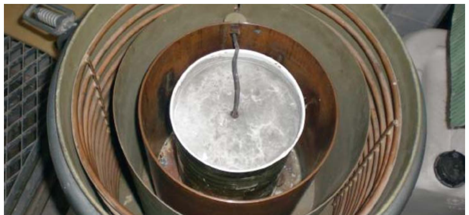
Bild 1: Betonkalorimeter zur Bestimmung des adiabatischen Temperaturverlaufs
