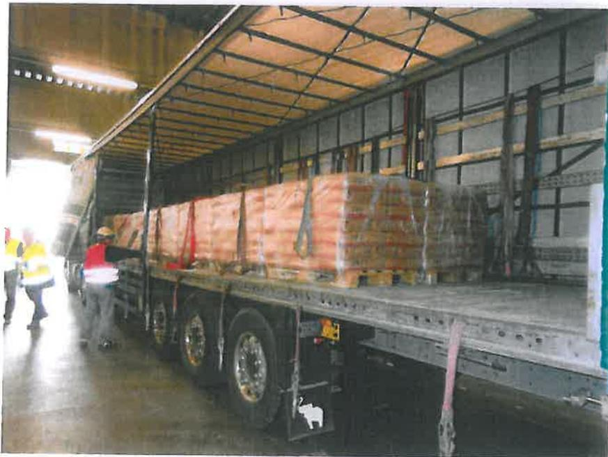
**Abbildung 12 Versuchsladung Bremsproben**
