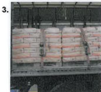
... jede Reihe einmal mittig niederzurren Mit einer Ratsche von S_{TF} 300 daN vorspannen
