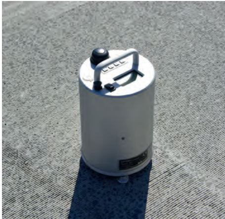
Abbildung 7: Rautiefe mit ELAtextur-Messgerät auf Grinding-Textur
