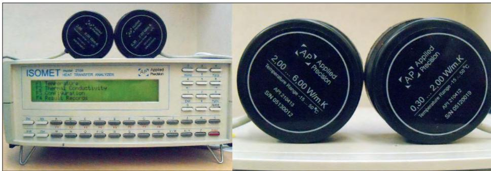
Bild 2. Prüfgerät zur Bestimmung der Wärmeleitfähigkeit mit Oberflächensensoren (r.)
