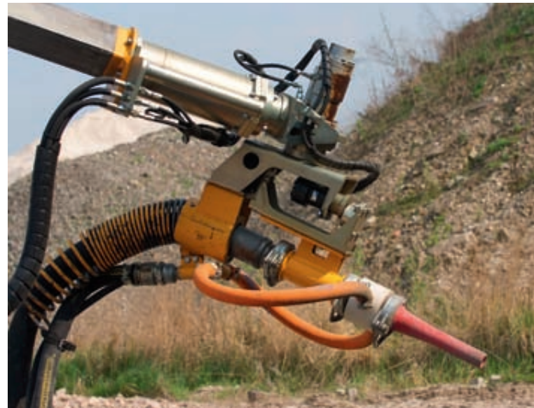
1 Düse mit Druckluft und Beschleuniger-Zugabe
