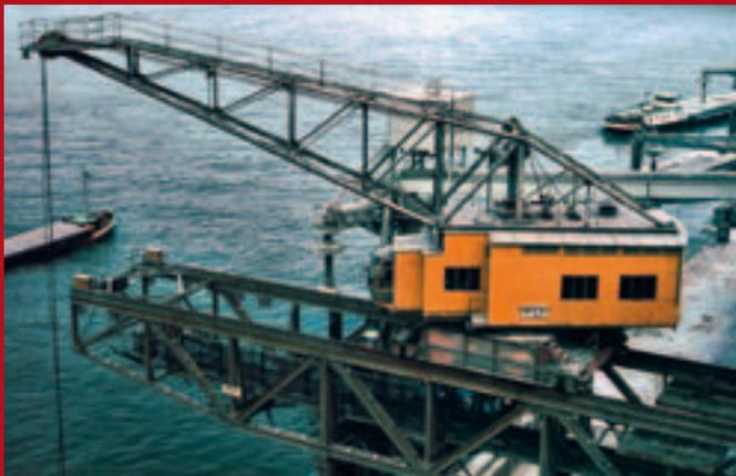
Neuer DREHKRAN bestehend aus einer 64 m langen fahrbaren Brücke vom Rhein bis ins Werksinnere, mit einer Ausladung von 18 m. Tragkraft 8 t bei einer Gesamthöhe von 27 m und einem Greiferinhalt von 5 m<sup>3</sup>. In erster Linie diente der Kran dem Kohle- und Klinkerumschlag sowie für das Entladen von Hochofenschlacke und Gips. Der Gesamtumschlag belief sich auf monatlich 25 bis 30.000 t.
