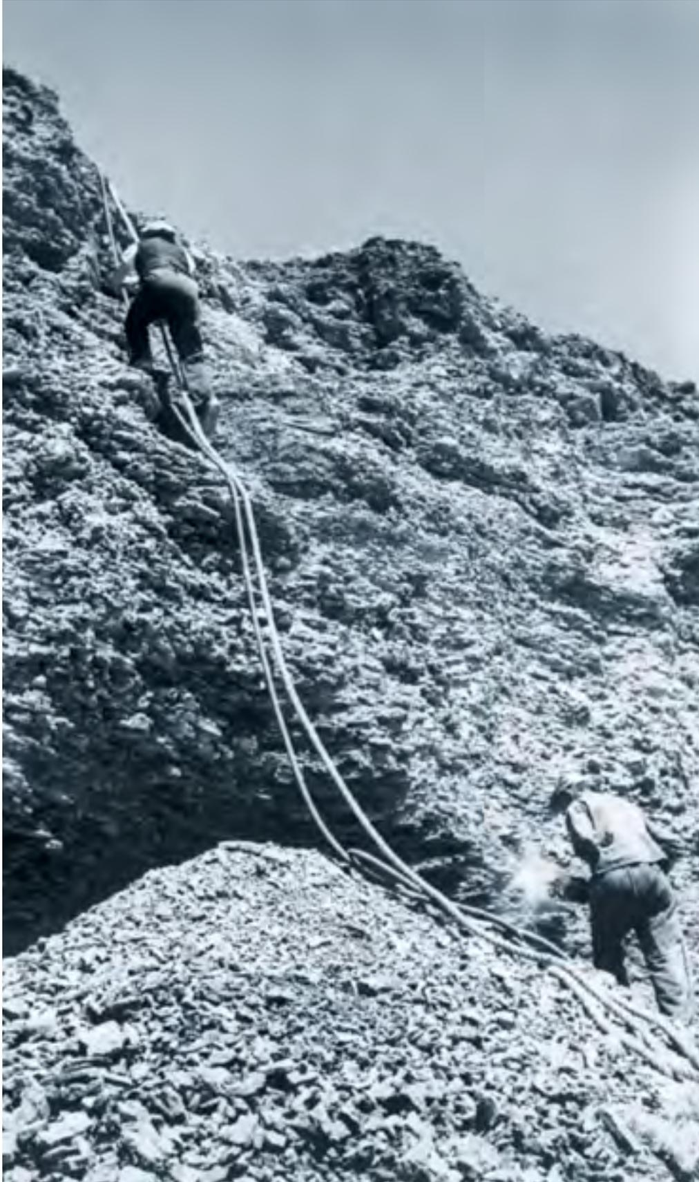
Abbau im Rolloch mit Flottmann-Presslufthämmern, ca. 1935.
