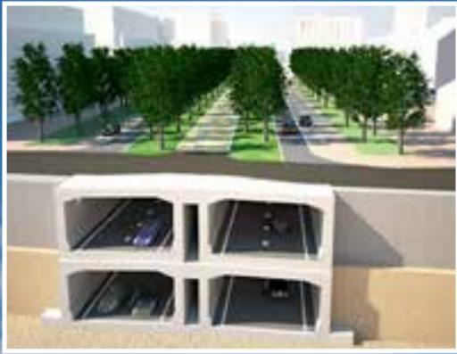
Auf beiden Ebenen sind jeweils ein Fluchttunnel und ein Kabelkanal vorgesehen, so dass die Verkehrsströme auch im Notfall unabhängig voneinander sind. Jede Röhre wird mit einer eigenen Leitung entwässert. Eine Standspur ist wie in vielen Tunneln in den Niederlanden nicht vorgesehen.
