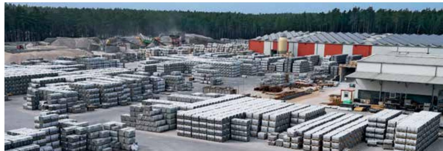
Auf dem 26 Hektar großen Firmengelände in Högling wird in neun Hallen gefertigt. Mehr als 100 Lkw liefern täglich circa 3.000 Tonnen Sand, Kies und Zement an. Fünf Pflastersteinmaschinen und zwei Plattenpressen produzieren jeden Tag 20.000 Quadratmeter an Flächenbelägen. Mehr als 100 farbige Sande und Körnungen stehen für die verschiedenen Betonrezepturen zur Verfügung.
