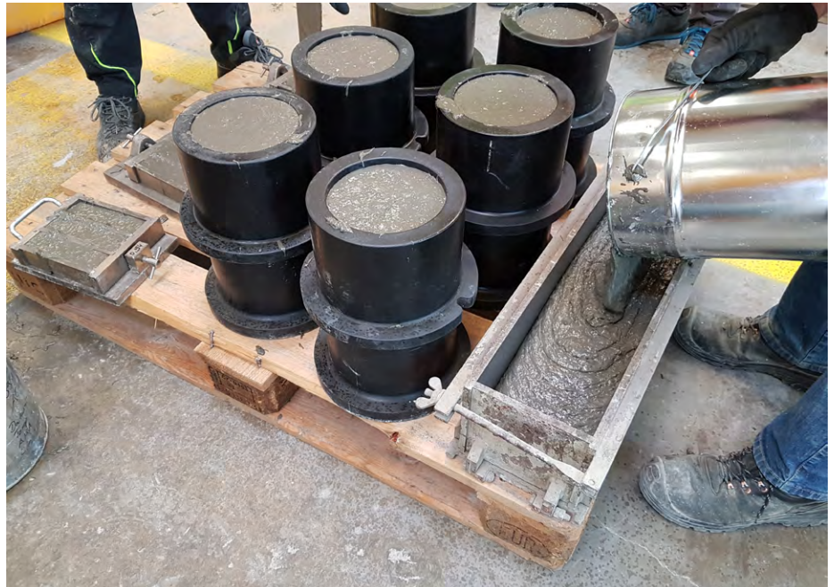
↑ Abbildung 2: Herstellung der Probekörper für die Festbetonprüfungen (© Max Bögl Fertigteilwerke GmbH, Sengenthal)
