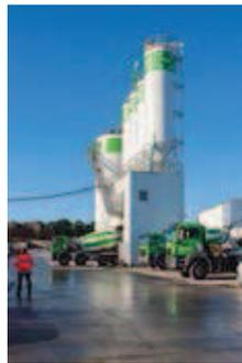
Für das Pilotprojekt wurde der Bankettbeton von der TBW Warendorf im Werk Münster hergestellt und in Fahrmischern zur Einbaustelle geliefert.
