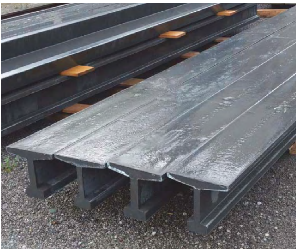
← Abb. 4: Träger aus ultrahochfestem Beton mit Carbonbewehrung [8]
