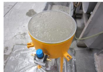
► Prüfung des Blutens von Beton: ist die Prüfung mit der Betonfilterpresse nach ÖVBB-Merkblatt „Weiche Betone“ eine Alternative?
