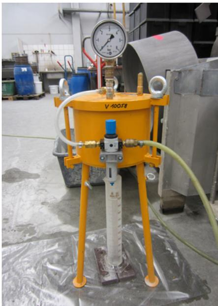
↑ Abbildung 1: Betonfilterpresse nach ÖVBB-Merkblatt „Weiche Betone“
