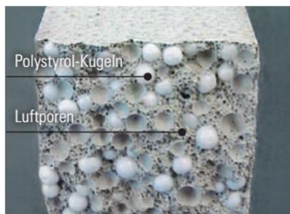
Ausgehärteter Poriment LS im Querschnitt
