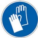
Wasserdichte, abrieb- und alkaliresistente Schutzhandschuhe tragen. Lederhandschuhe sind auf Grund ihrer Wasserdurchlässigkeit nicht geeignet und können chromathaltige Verbindungen freisetzen. Beim Verarbeiten des Baustoffes sind keine Chemikalienhandschuhe (Kat. III) erforderlich. Untersuchungen haben gezeigt, dass nitrilgetränkte Baumwollhandschuhe (Schichtdicke ca. 0,15 mm) über
