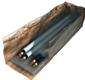
CableCem im Kabel-Hüllrohrsystem
