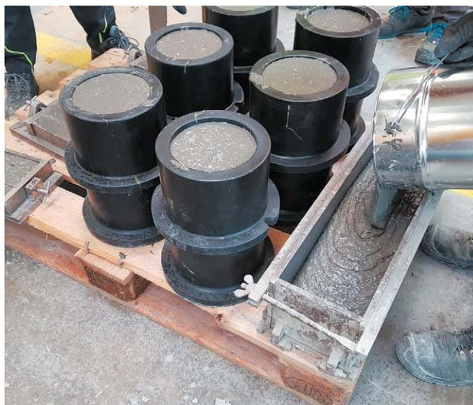
Bild 2: Herstellung der Probekörper für die Festbetonprüfungen
