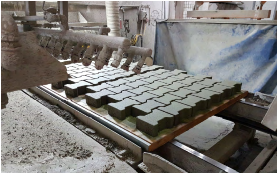
↑ Abbildung 6: Pflastersteinproduktion mit dem neuen CEM II/A-LL 42,5 R bei einem Kunden
