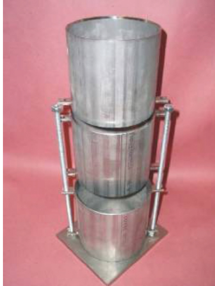
↑ Bild 1: Zylinderform für den Auswaschversuch nach SVB-Richtlinie des DAfStB, Ausgabe November 2003
