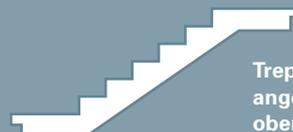
Treppenlauf mit angeformten Podest oben und unten
