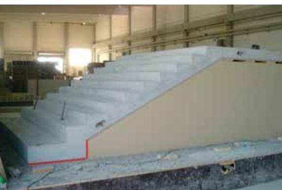
← Treppenlauf mit angeformtem Podest oben und unten
