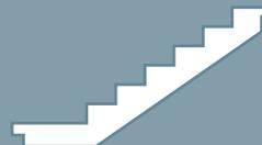
Treppenlauf mit angeformten Podest unten
