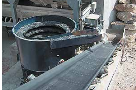
↑ Bild 32 b: Rütteltrichter zur Aufgabe von Stahlfasern
