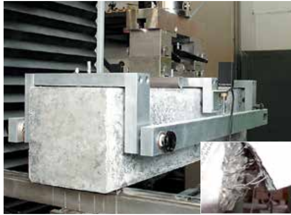
↑ Bild 5: Stahlfaserbeton Balkenprüfung
