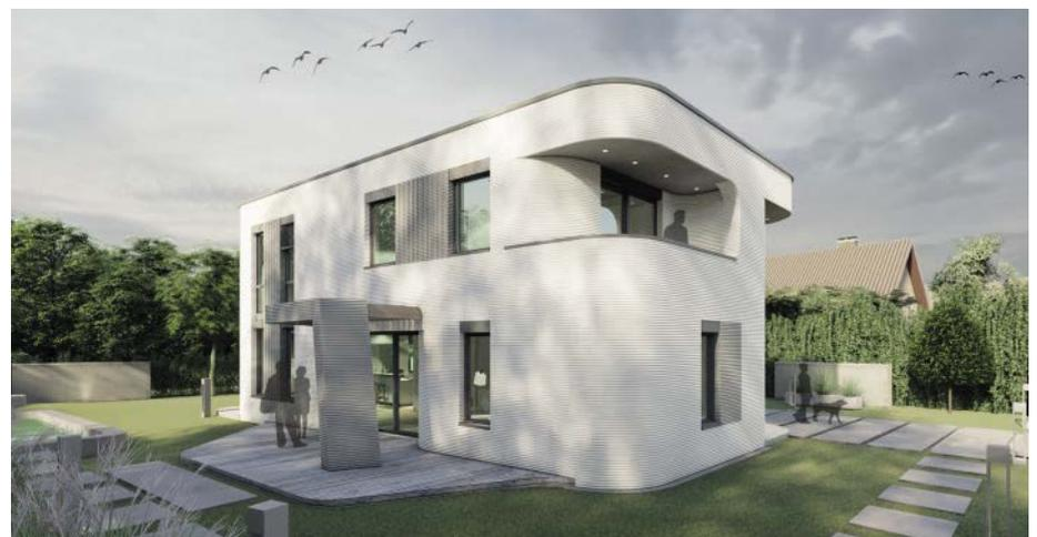
**Bild 3: Animation des ersten in Deutschland mittels 3D-Betondruck realisierten Gebäudes**
