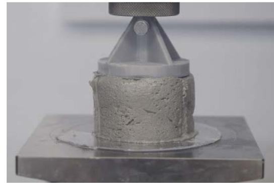
**Bild 2: Untersuchung der Stabilität des Druckmörtels im Labor** Foto: HeidelbergCement Group
