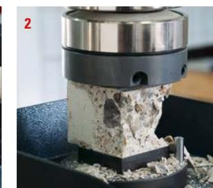
**2** Druckfestigkeitsprüfung bei einem Fließestrich
