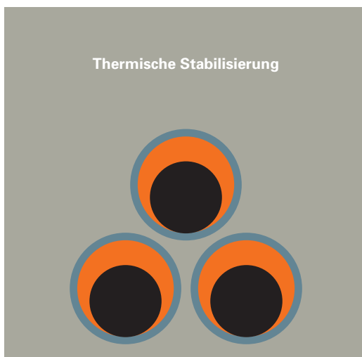
← Abbildung [1]: Dreiecksanordnung eines 110-kV-VPE-Kabelsystems mit Legung in Kunststoffrohren innerhalb eines thermisch stabilisierten Bereichs. Abmessungen: 0,7 m x 0,8 m; V' \approx 0,55 \text{ m}^3/\text{m}
