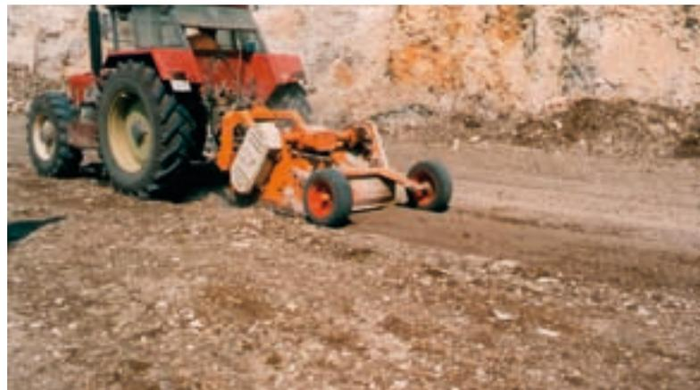
Abb. 18: Steinfräse zur Vorbereitung des Bodens.
