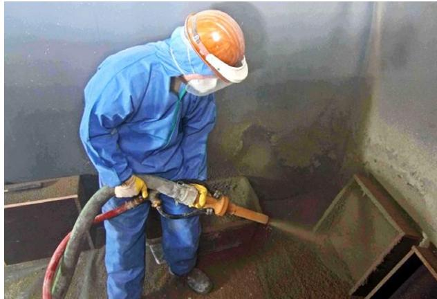
↑ Abb. 2: Herstellung von Prüfplatten (sog. „Spritzkisten“) im Laborspritzversuch
