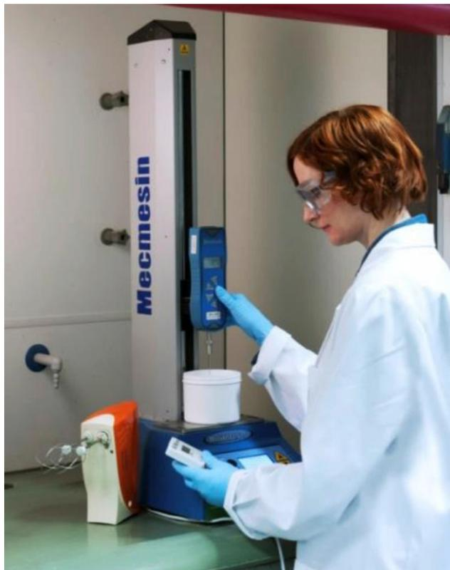
↑ Abb. 3: Versuchsaufbau zur Durchführung des Beschleuniger-Systemtests (BEST) mit automatisiertem Vorschub
