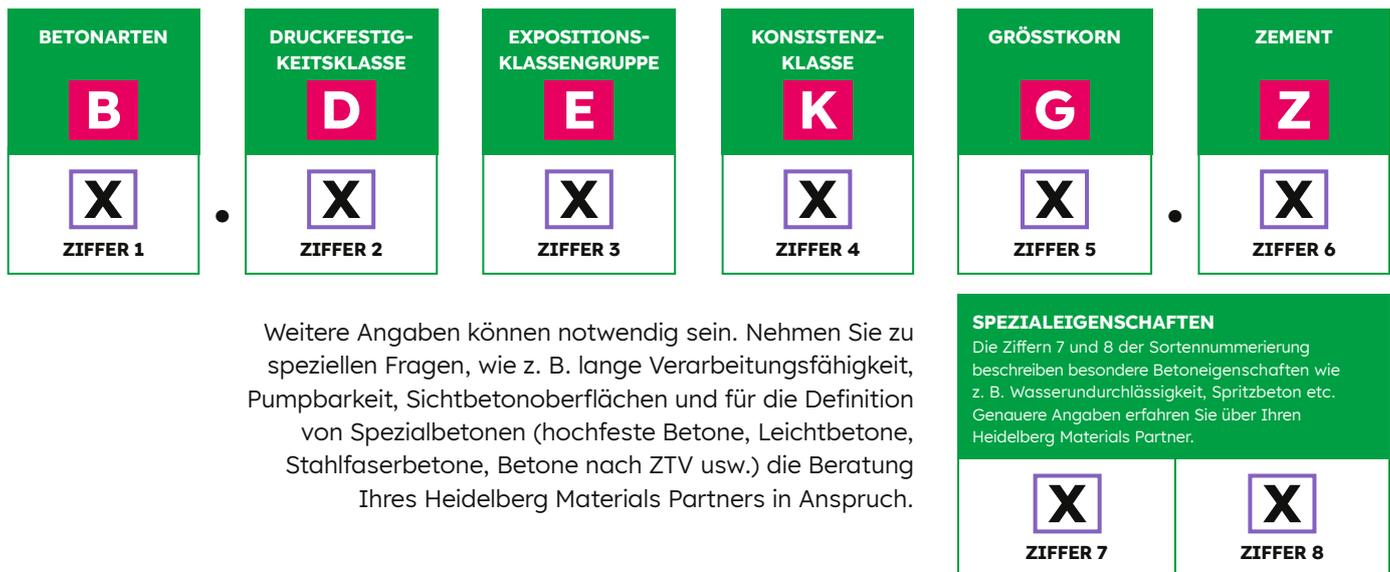
Weitere Angaben können notwendig sein. Nehmen Sie zu speziellen Fragen, wie z. B. lange Verarbeitungsfähigkeit, Pumpbarkeit, Sichtbetonoberflächen und für die Definition von Spezialbetonen (hochfeste Betone, Leichtbetone, Stahlfaserbetone, Betone nach ZTV usw.) die Beratung Ihres Heidelberg Materials Partners in Anspruch.
