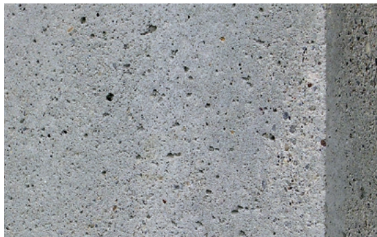
Bild 5e: Oberfläche sandgestrahlt
