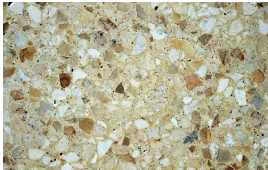
Bild 5b: Schleifen und Polieren
