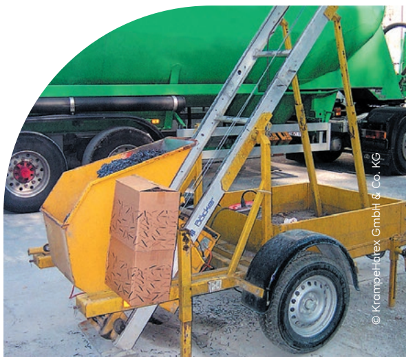
Bild 35 a: Aufzug zur Zugabe von Stahlfasern in den Mischer
