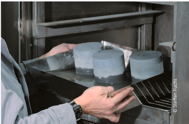
Hauseigener Frost-Tau-Wechsel-Versuch im Wasserbad
