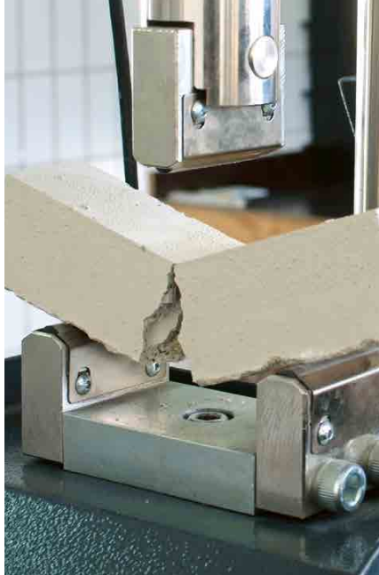
Biegezugfestigkeitsprüfung bei einer Fließestrichprobe.
