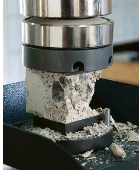
Druckfestigkeitsprüfung bei einer Fließestrichprobe.
